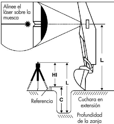
Para calcular la altura de instalación, mida primero la altura del instrumento (HI) y añada la profundidad de la zanja (C) para calcular la profundidad total ( $L = C + HI$ ).
