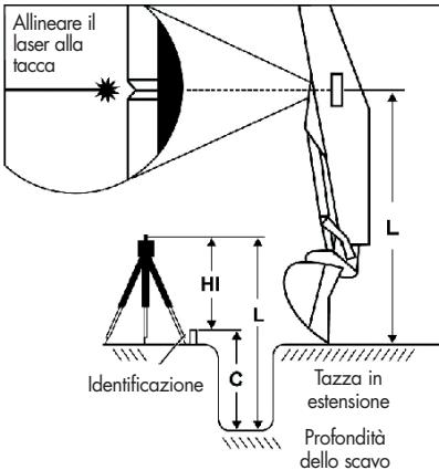
Per calcolare l'altezza d'installazione, misurare innanzitutto l'altezza dello strumento (HI); aggiungere la profondità dello scavo (C) per ricavare la profondità totale ( $L = C + HI$ ).
