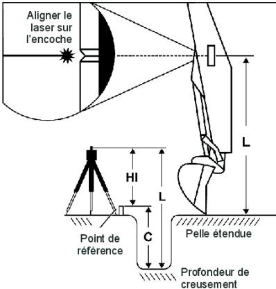
Pour calculer la hauteur d'installation, mesurer d'abord la hauteur de l'instrument (HI) ; y ajouter la profondeur de la tranchée (C) pour en déduire la profondeur totale ( $L = C + HI$ ).
